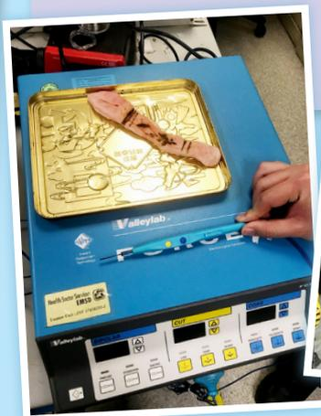
學生在機電署專家教導下，嘗試在醫院電子工程部，以電動手術刀切割動物皮膚組織。
